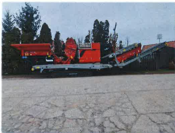
Mobilný odrazový drvič SBM REMAX 200
