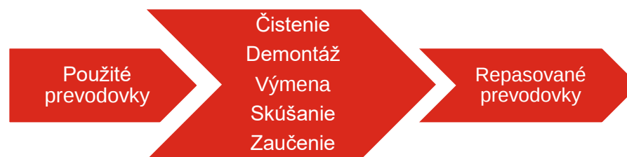
Obrázok 35: Proces obnovy použitej prevodovky
