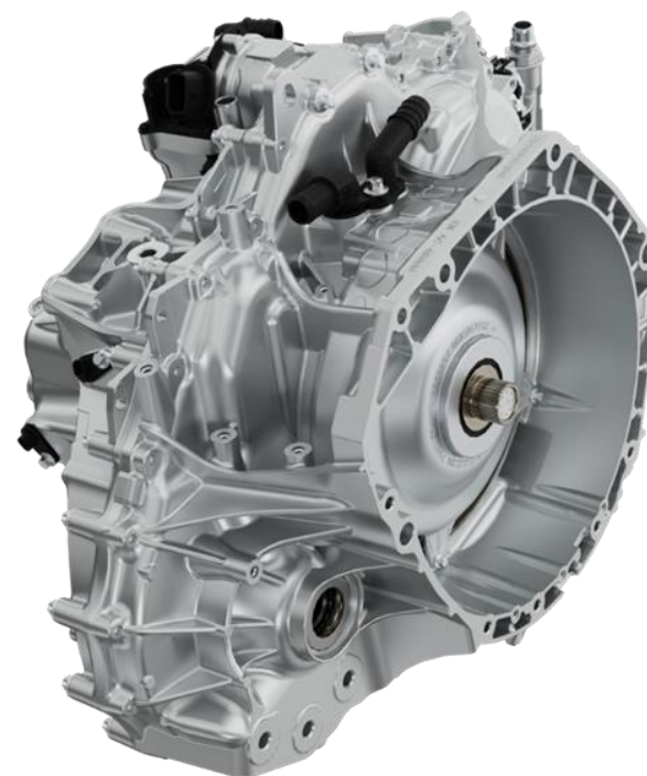
Obrázok 8: 7HDT300 48V hybridná dvojspojková prevodovka
