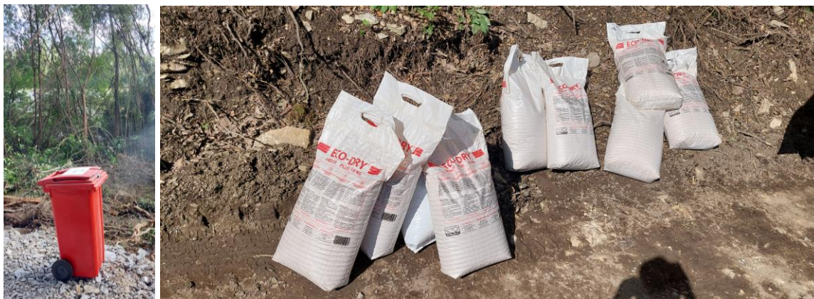
Havarijná súprava a sorbent na zamedzenie úniku ropných látok do vody a pôdy
