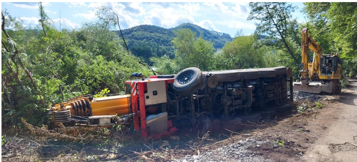
Prevrátenie autožeriavu pri presune k cyklolávke pri výstavbe cyklotrasy Považský Chlmec – Budatín (Žilina)
