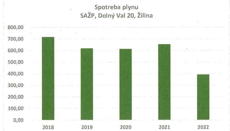
V objektoch v správe organizácie sú prevádzkované automatické kotle (výkon do 300 kW). Spotreba plynu závisí od dĺžky vykurovacej sezóny a vonkajšej teploty. Systém sa automaticky spúšta pri dosiahnutí nastavenej teploty. V roku 2021 nastal mierny nárast z dôvodu dĺžky vykurovacej sezóny. V roku 2022 organizácia pristúpila k zavedeniu opatrení na zníženie energií a určenie 1 dňa home office.
