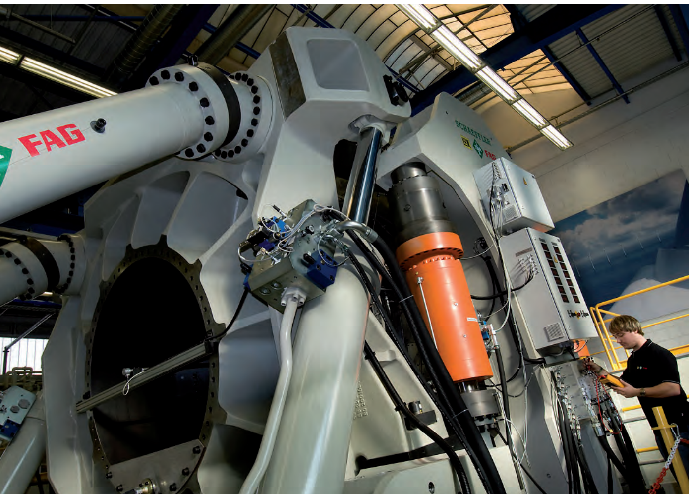
Skúšobná stanica veľkých ložísk ASTRAIOS
