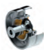
radiálne gul'kové ložiská s nastre- kovanou plastovou alebo nalisova- nou kovovou remenicou
