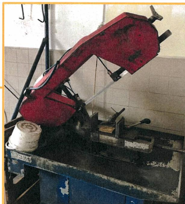
Komentár k fotografii: Nová pásová píla na presné rezanie odpadových Ni-Cd batérií a akumulátorov.
